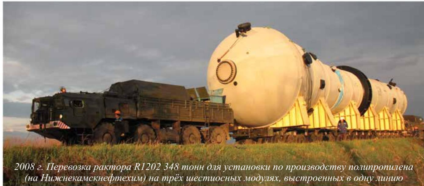
2008 г. Перевозка рактора R1202 348 тонн для установки по производству полипропилена (на Нижнекамскнефтехим) на трёх шестиосных модулях, выстроенных в одну линию
