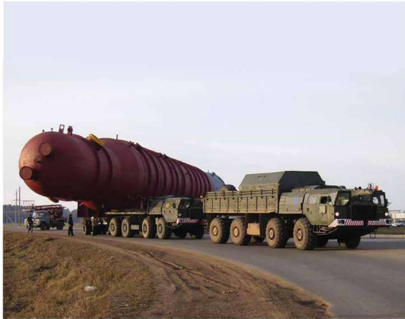
2008 г. Перевозка колонны С0401 340 тонн для установки ЭЛОУ-АВТ ОАО «ТАНЕКО» на трёх шестиосных модулях, выстроенных в одну линию
