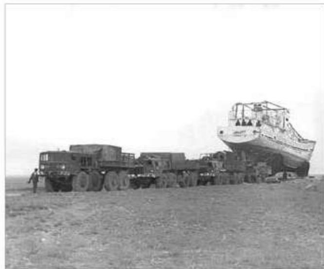
Города проходили ночами, ждали, когда уйдут с линий троллейбусы, когда поднимут и отключат провода. Последние километры шли через горы. Свирепо рыча, «Ураганы» брали перевал, с которого открывался долгожданный Иссык-Куль...» Точнее, автопоезд с кораблем успешно прибыл в г. Рыбачье, где на слипе судостроительного завода под кильблоки были подставлены опоры, и ЧМЗАП, опустив платформу, выехал из-под судна. «Спецтяжавтотранс» закончил свою работу.
